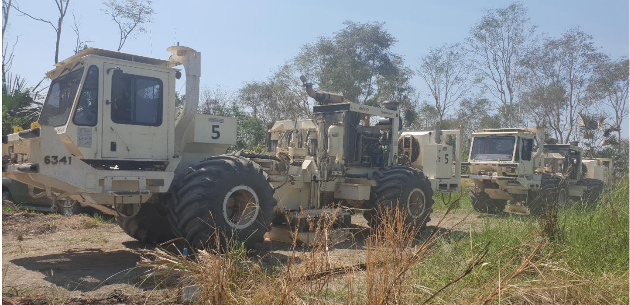
Figura 7: Camiões vibradores (vibroiseis trucks) durante aquisição sísmica 2D no Bloco C
