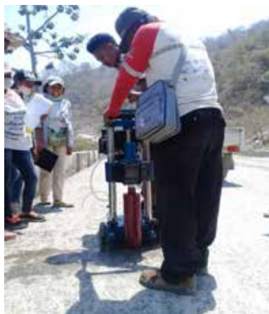
Técnicos da ADN realizam teste "profiling" no projeto da estrada Manatuto.
